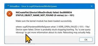
Il peut être nécessaire d'installer un driver situé dans C:\Program Files\Oracle\VirtualBox\drivers\vboxsup
