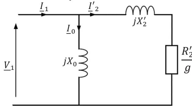
Figure 9. Modèle équivalent d'une phase du moteur asynchrone
