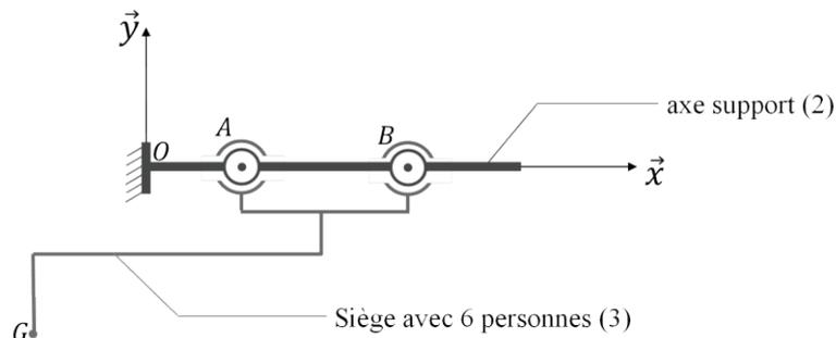
Figure 16. Liaisons entre l'axe support et le siège
