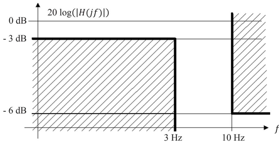
Figure 14. Gabarit du filtre à l'entrée du module de l'automate
