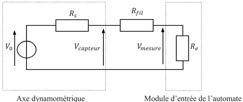
Figure 13. Modélisation électrique de la connexion du capteur sur le module d'entrée automate
