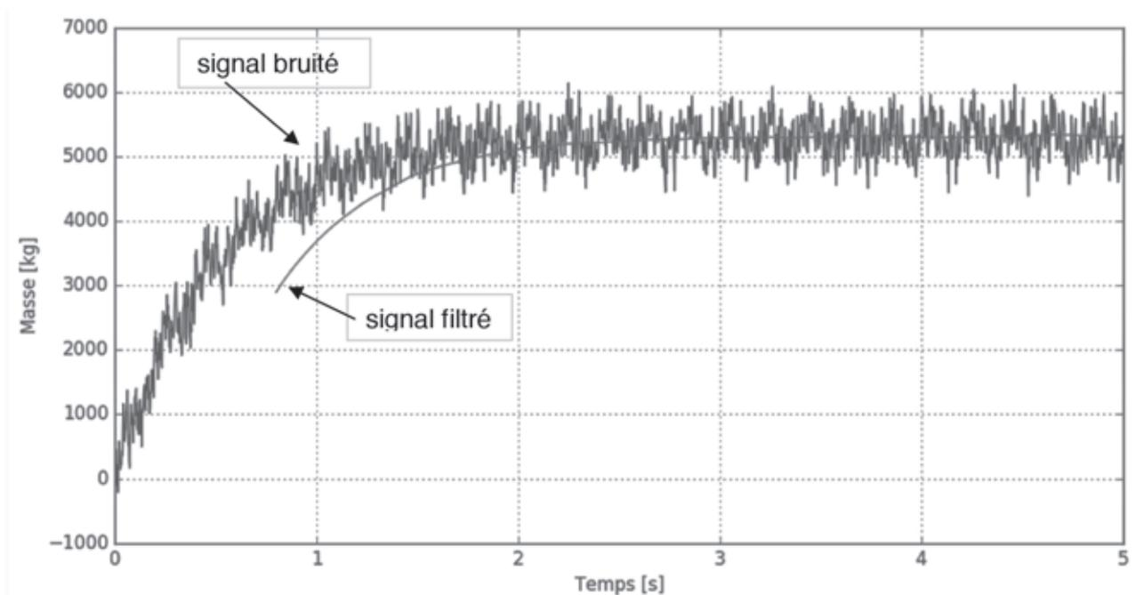
Figure S4 - Filtrage gaussien du signal bruité
