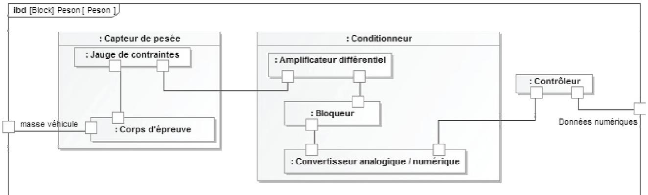
Figure 5 - Modélisation SysML - diagramme interne du bloc peson
