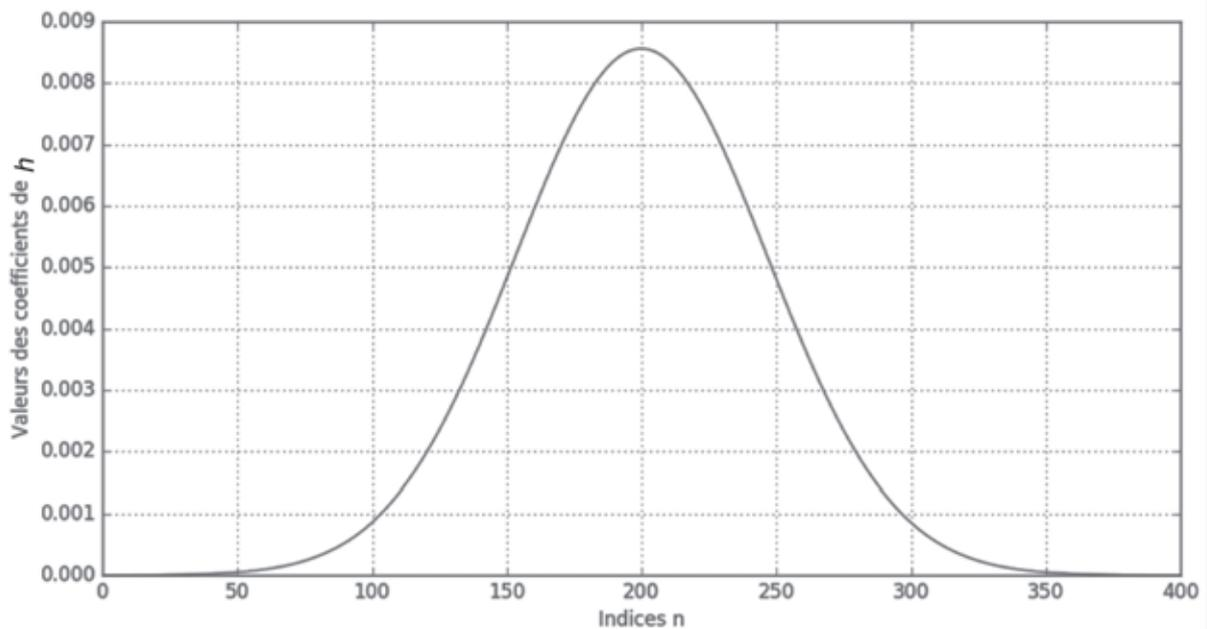
Figure S3 - Réponse impulsionnelle du filtre gaussien
