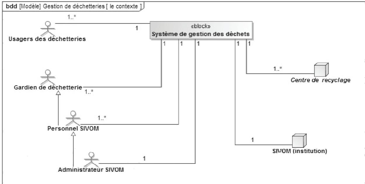
Figure 1 - Modélisation SysML - diagramme de contexte du système
