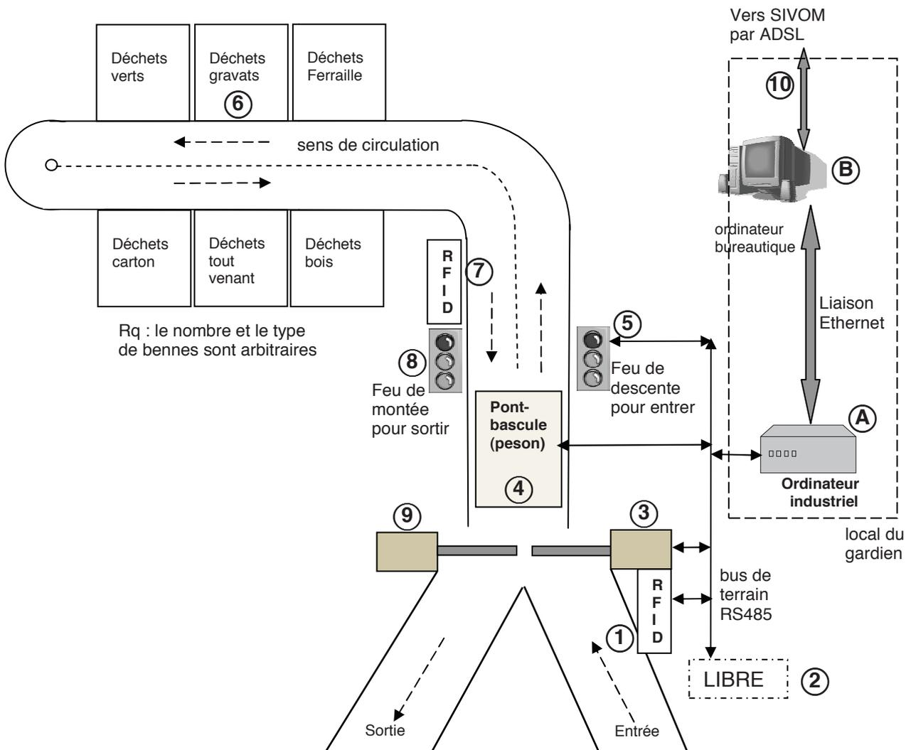
Figure 2 - Schéma de principe du fonctionnement d'une déchetterie
