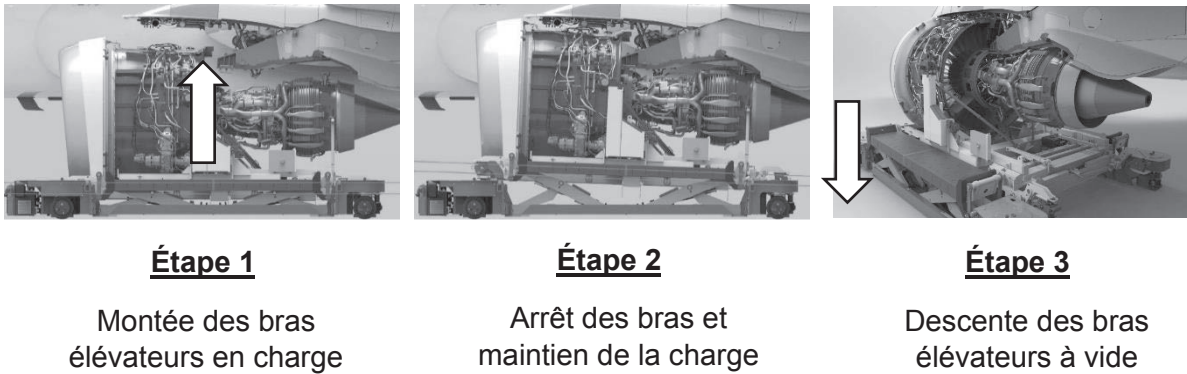
Figure 5 - Étapes pour la pose d'un moteur
