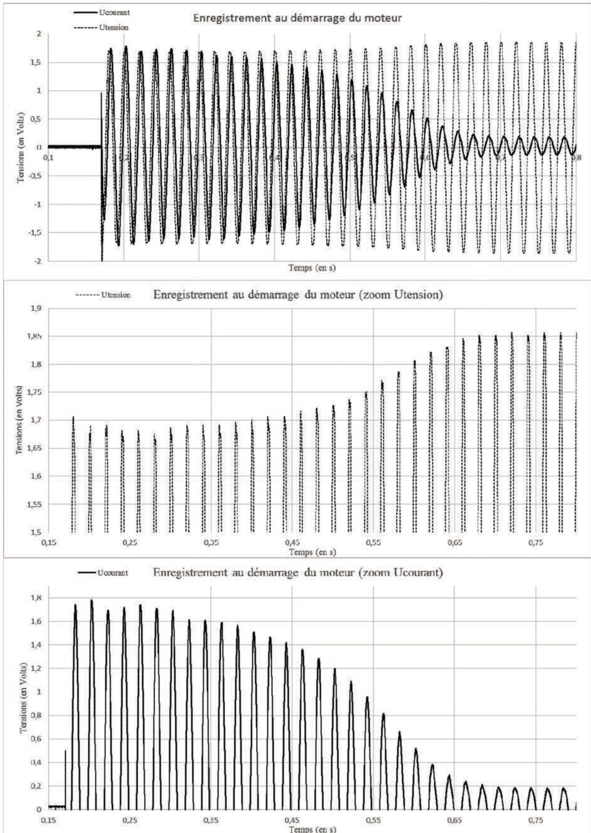
**Figure 7** – Enregistrement de  $u_{tension}(t)$  et  $u_{courant}(t)$  lors du démarrage du moteur non-chargé. Les deux figures du dessous sont des zooms séparés de  $u_{tension}(t)$  et  $u_{courant}(t)$
