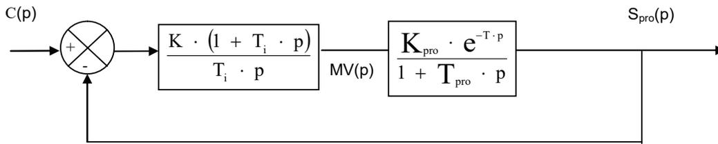
**Figure 9** – Structure de la commande avec correcteur PI
