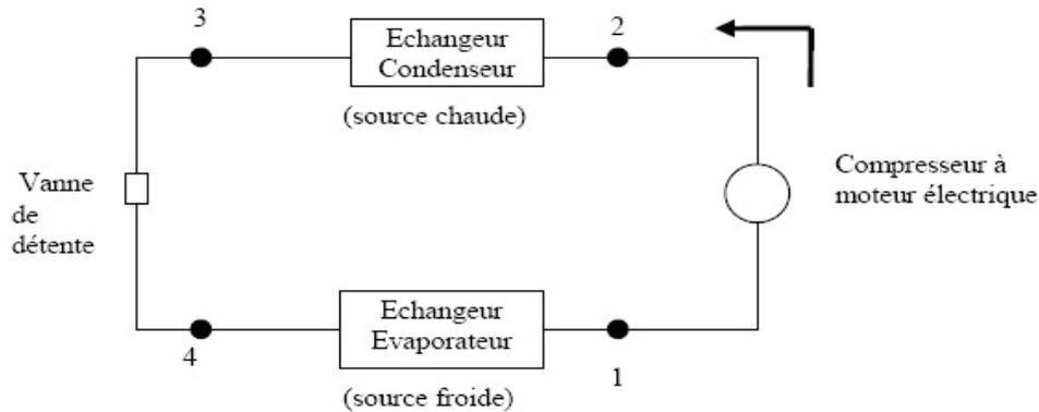
**Figure 2** – Les quatre organes de la machine frigorifique
