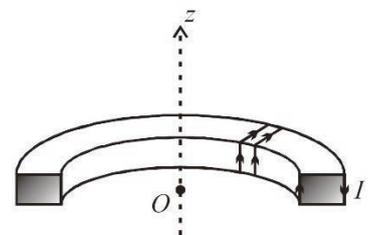
**Figure 8** – Schéma d'une moitié de bobine torique
