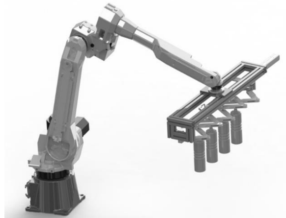
Figure 8 - Robot de manutention du pantographe
