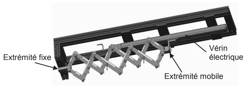
Figure 10 - Vérin électrique d'ajustement de l'entraxe du pantographe
