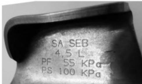
**Figure 4** - Indications sur l'autocuiseur
