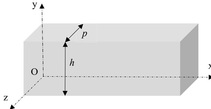
**Figure 2** - Conducteur parallélépipédique semi-infini
