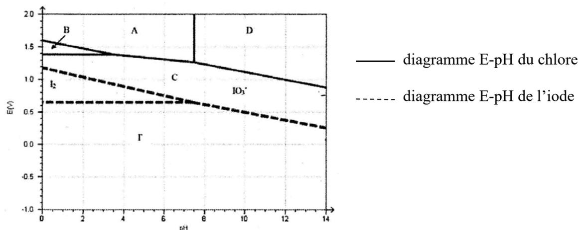
Figure 19 - Diagrammes E-pH du chlore et de l'iode
