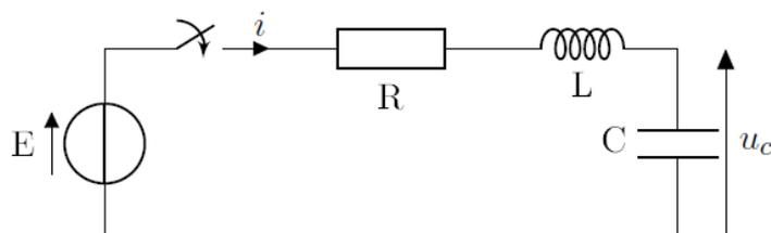
**Figure 1** - Circuit RLC alimenté par une tension continue
