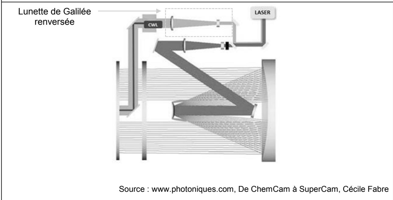
Le dispositif décrit correspond à un système en configuration afocale qui sera modélisé à l'aide de deux doublets afocaux constitués de lentilles simples positionnées sur un axe optique unique.
