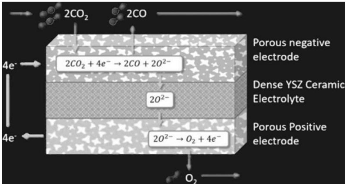
Où YSZ désigne l'oxyde de zircon stabilisé à l'yttrium (substitution partielle d'ions zirconium par des ions yttrium dans l'oxyde  $\text{ZrO}_2$ )
