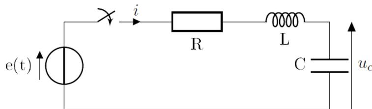
**Figure 2** - Circuit RLC alimenté par une tension variable
