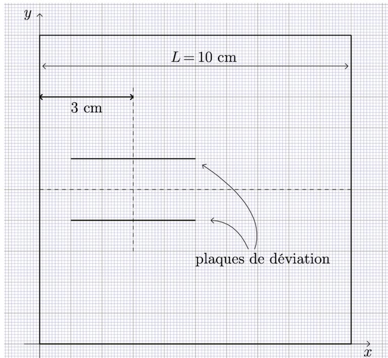
**Figure 8** – Modélisation des plaques de déviation dans l’enceinte
