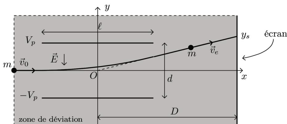
**Figure 7** – Schéma de la zone de déviation
