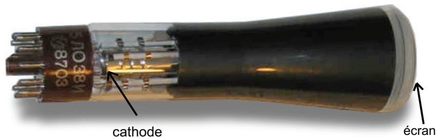
**Figure 6** – Petit tube d'oscilloscope, de longueur d'environ 20 cm
